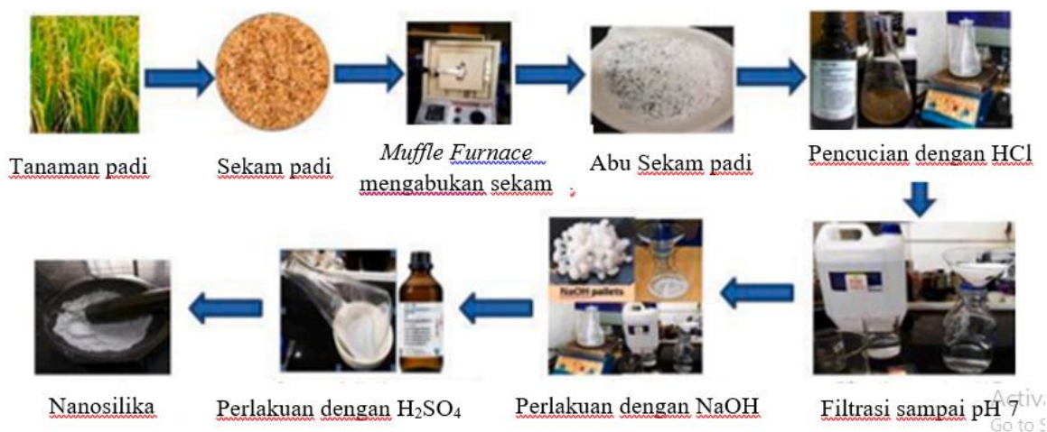
Gambar 4. Diagram skema sintesis nanosilika dari sekam padi menggunakan metode sol-gel [33]
