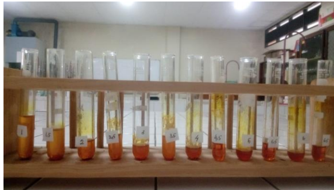
Gambar 2. Uji Warna Ekstrak Kulit Manggis pada Larutan dengan Variasi pH Asam
