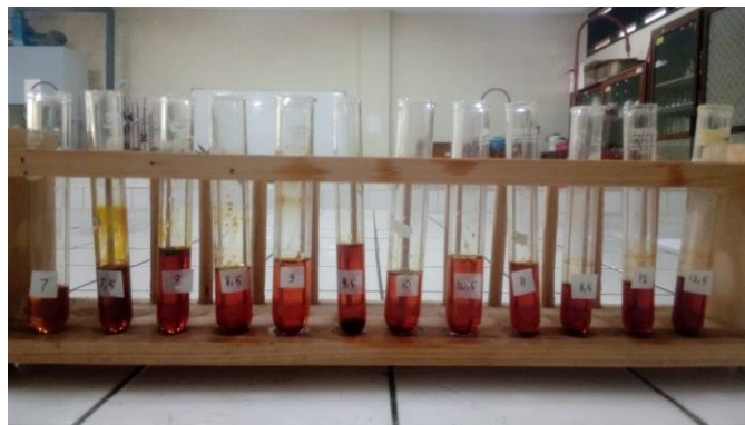
Gambar 3. Uji Warna Ekstrak Kulit Manggis pada Larutan dengan Variasi netral hingga pH Basa
